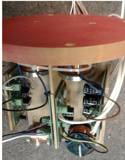
Het filter met impedantiecompensatoren klaar om in de box gemonteerd te worden.
