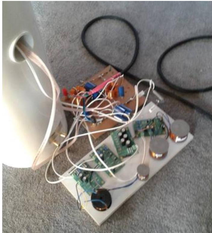
Op de witte plank impedantie compensatie (3x) per unit en voor poort, vier stuks totaal dus, op bruine plank het scheidingsfilter.
